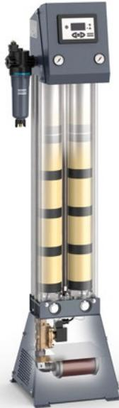
Die kaltregenerierenden Adsorptionstrockner sind für eine lange Lebensdauer ausgelegt. Hochwertige Bauteile, die für einen geringen Differenzdruck und eine erhöhte Zuverlässigkeit konstruiert wurden, sorgen für einen ausfallsicheren Betrieb. Die Trockner sind teilweise mit aktiviertem Alumina (-20 und -40 °C ohne plus) und mit Cerades für (-20 und -40 °C alle plus-Ausführungen) gefüllt. Für den -70 °C Bereich sind die Trockner mit Molekularsieb gefüllt.
